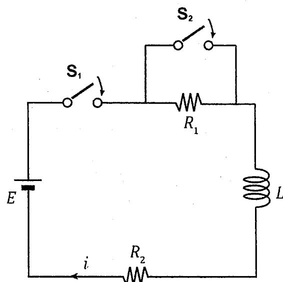
1.  $0 \leq t \leq T$  における回路方程式（微分方程式）をキルヒホッフの法則を用いて記述せよ。ただし、抵抗  $R_2$  を流れる電流を  $i$  とする。
